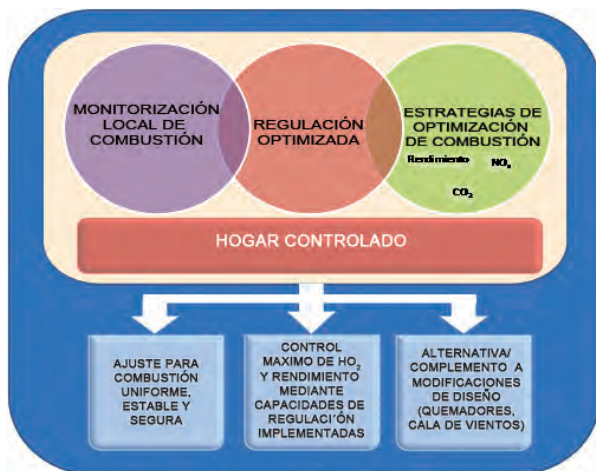
Fig. 1. Esquema conceptual de la tecnología de "Hogar controlado"
