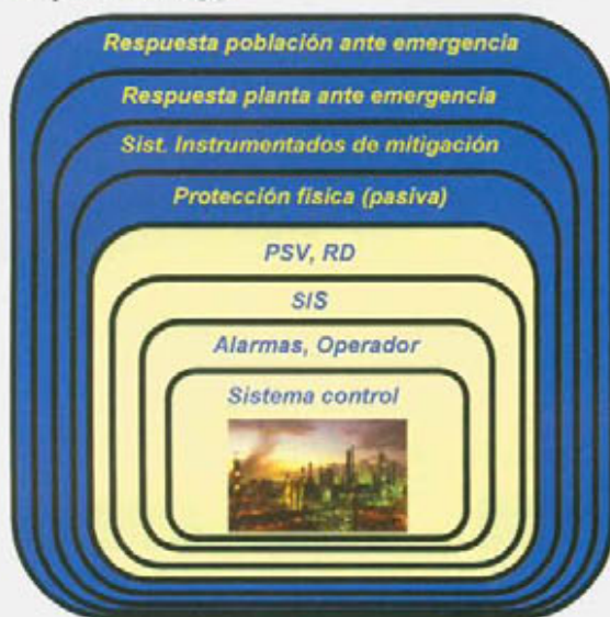
Capas de protección en instalaciones de proceso. Fig.3
