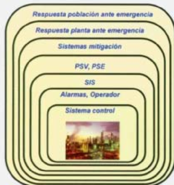
Fig. 1. Capas de protección en instalaciones de proceso
