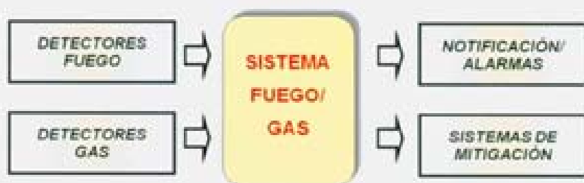
Fig. 2. Arquitectura de los sistemas fire & gas
