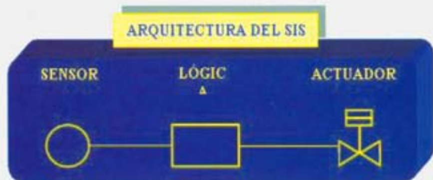
Arquitectura de un sistema instrumentado de seguridad
