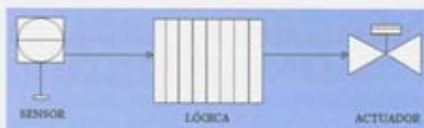
Figura 1 Arquitectura de un sistema instrumentado de seguridad
